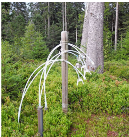
Abbildung 3 (links): Lysimeter sind fest installierte Saugkerzen, über die Bodenwasser aus unterschiedlichen Bodentiefen abgepumpt werden kann.
