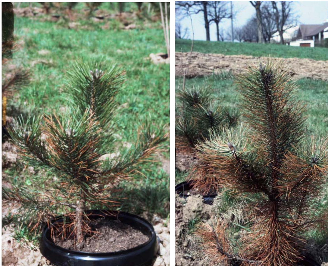
Foto 3: Mit Gischtsalz behandelte Pinus nigra (100 g/l): links \text{NaCl} , rechts \text{CaCl}_2 .
