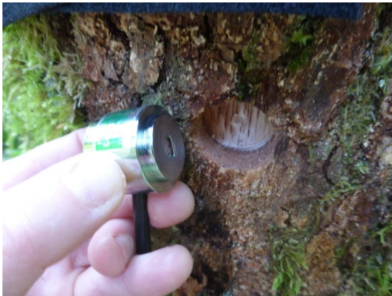
Foto 4: Stammpsychrometer bei der Installation (ICT Instruments).
