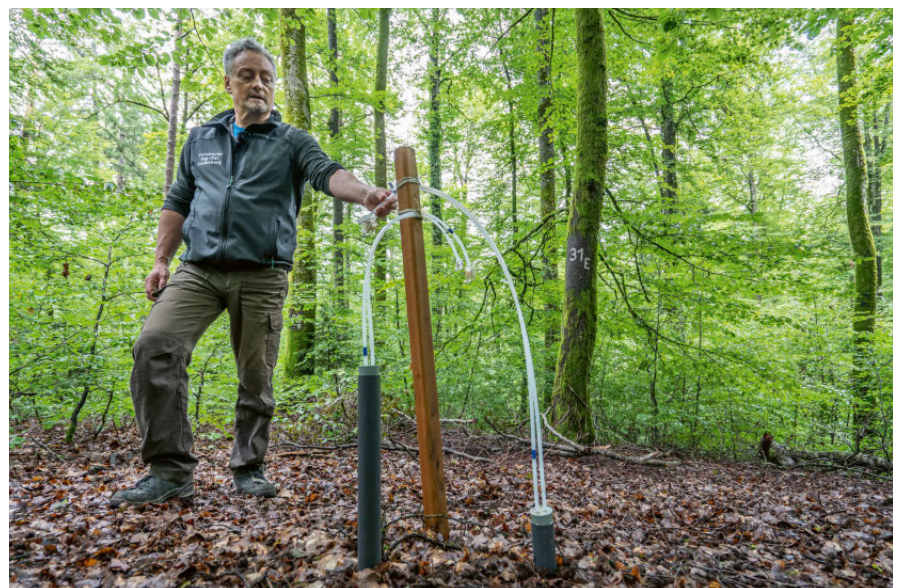
Versuchsaufbau in Bachs: die Möglichkeit einer Sanierung von tiefgründig versauerten Waldböden mittels Kalkung testen
