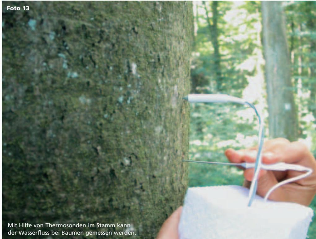
Mit Hilfe von Thermosonden im Stamm kann der Wasserfluss bei Bäumen gemessen werden.
